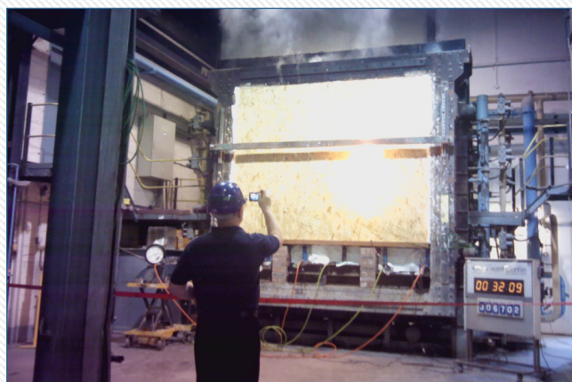
Рисунок 5: Испытание минерального волокна 306702, загоревшегося на 32-й минуте
