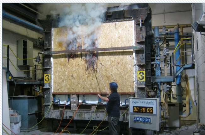
Рисунок 4: Испытание пенополиуретана 306703, загоревшегося на 38-й минуте
